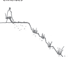
Pente aménagée en gradins enherbés
